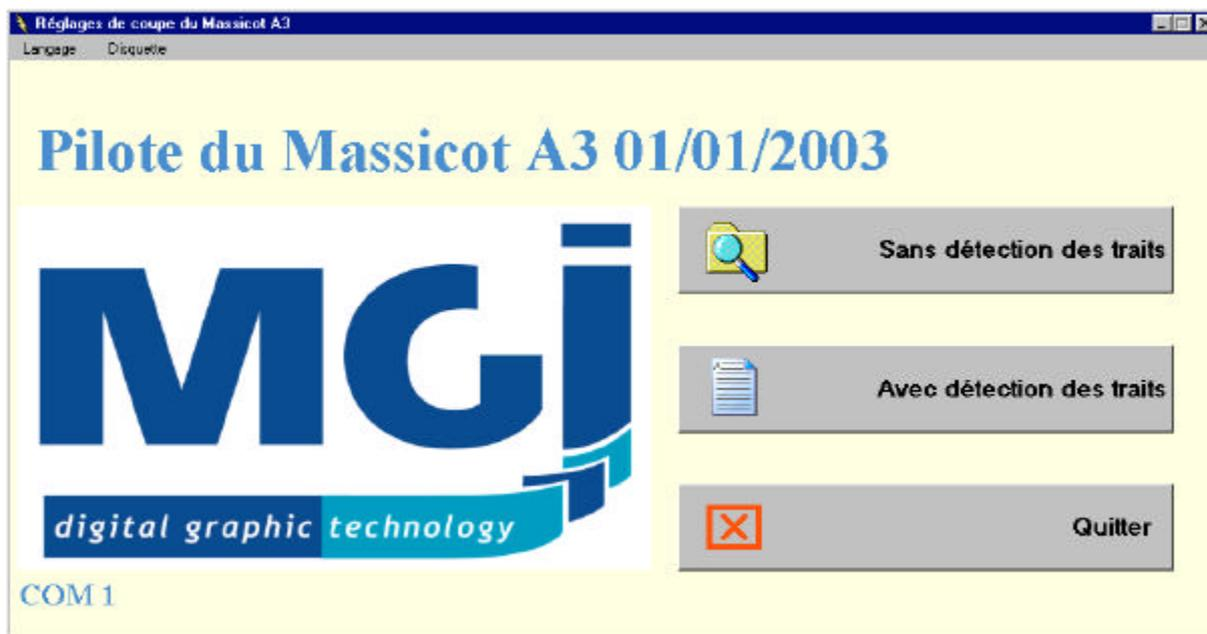
L'unité de finition peut fonctionner dans 2 modes : un mode 100% automatique où les différentes coupes sont détectées par les marques sur le bord de la feuille et un mode paramétré où l'utilisateur définit la position des coupes.
