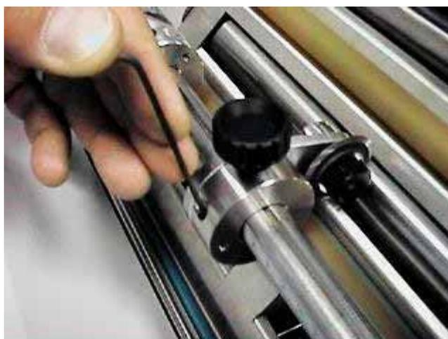
**Figure 3 : Régler la position de la lame**
